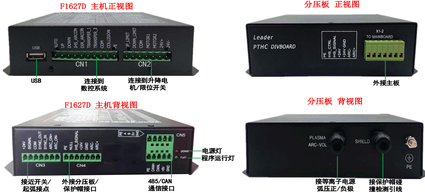
图 3.10 F1627D 机箱及分压板视图
