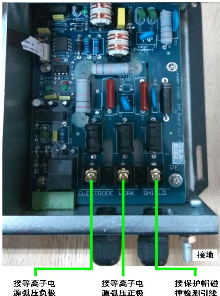
图 3.9 分压板接口接线
